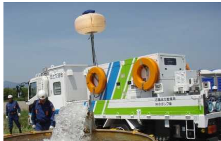
排水ポンプ車による特定緊急排水活動
