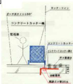
コンクリートカッターでガス管を切断した事故
