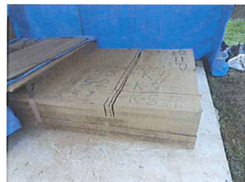
型枠解体後試験体
