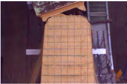
錘追加試験体 頂部圧壊 (kobe818gal)
