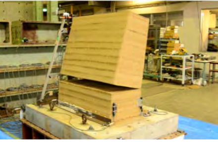
補強無しの試験体の浮上り破壊形式 (kobe818gal)
