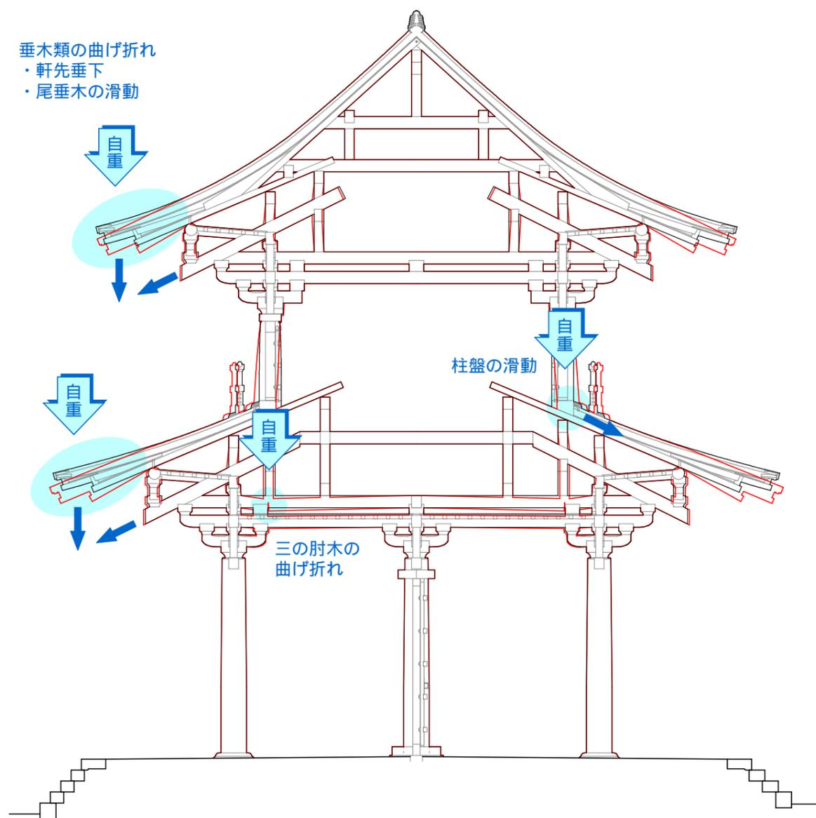
鉛直荷重による変形性状
