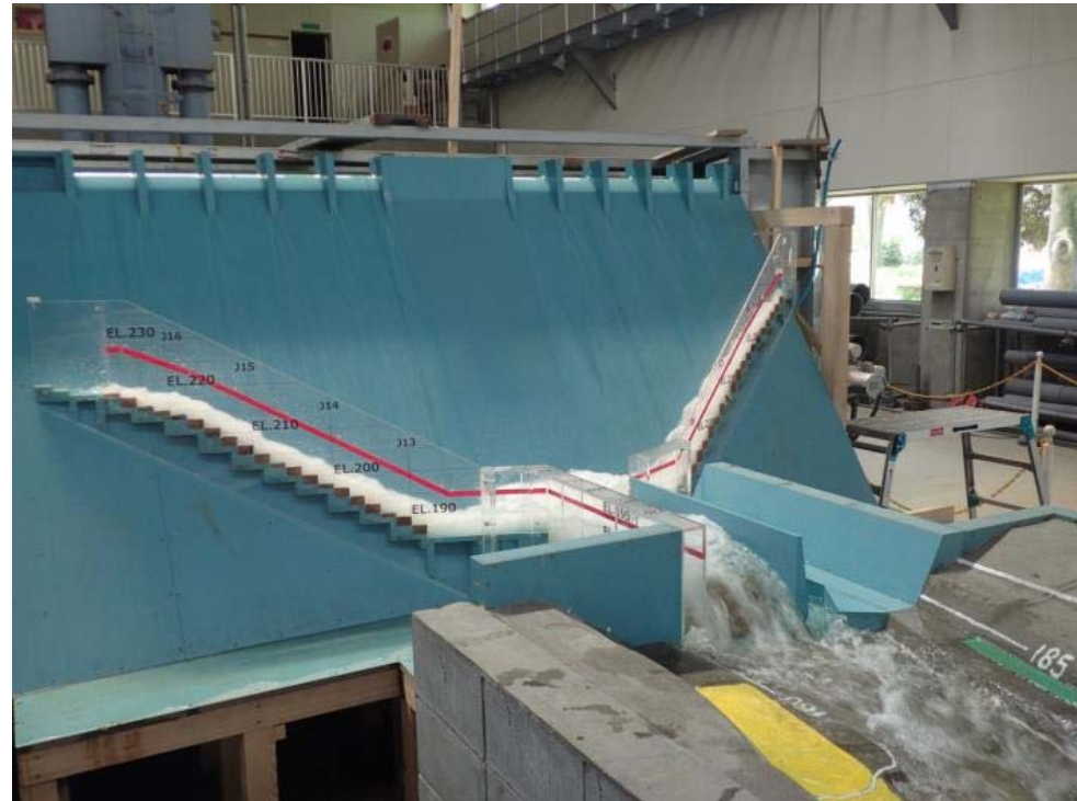
ダム本体水理模型実験状況
