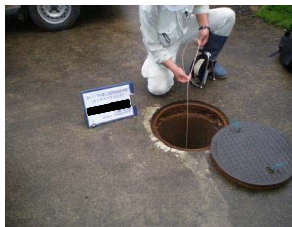
井戸6箇所: 水位手計観測 (掘込井戸他)
