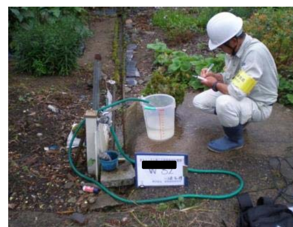
井戸16箇所: 揚水量手計観測 (打込井戸他)
