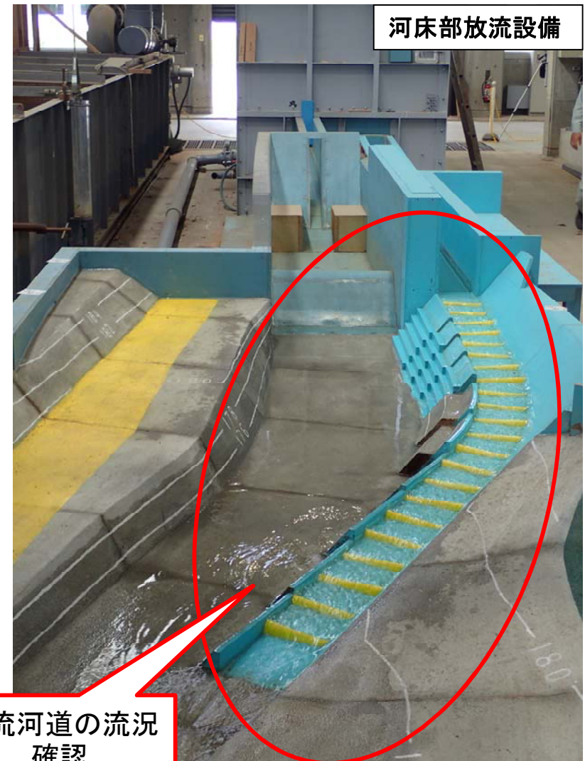
ダム本体水理模型実験状況(抽出模型)
