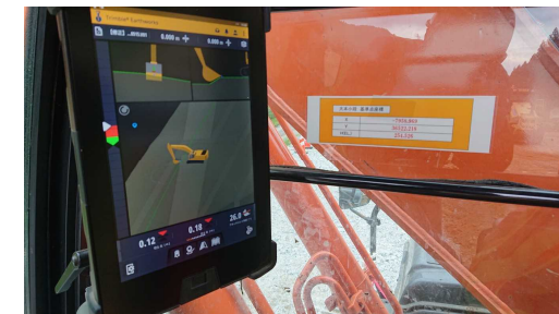
ICTバックホウ(マシンガイダンス)による法面整形
