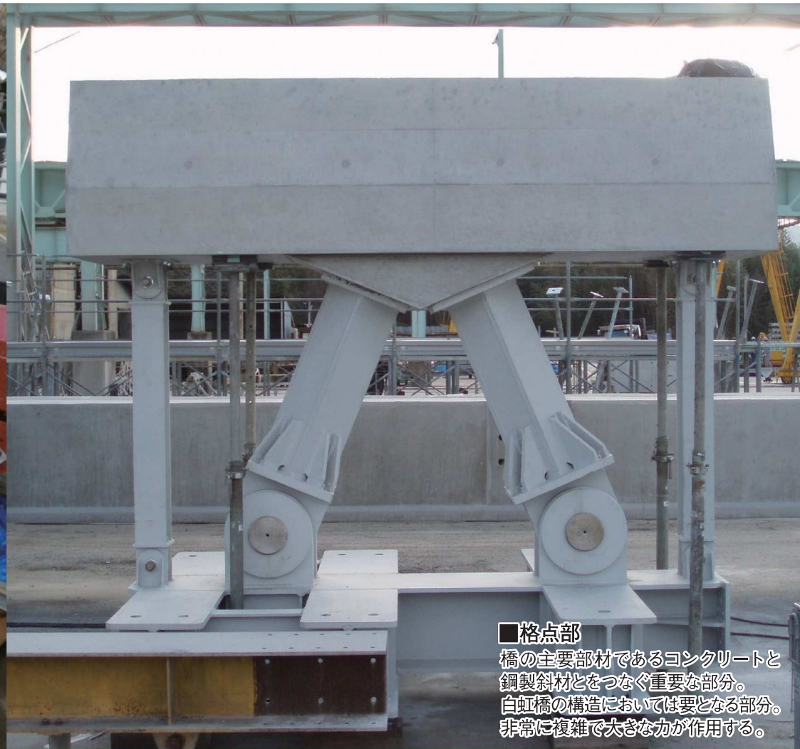
■ 載荷実験 実際の橋桁と同じ供試体を 製作し、荷重を加え、変形や 損傷の有無を確認する実験。
