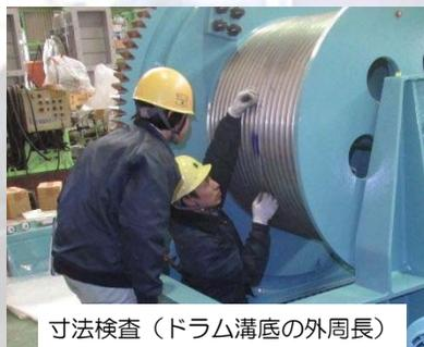
寸法検査（ドラム溝底の外周長）
