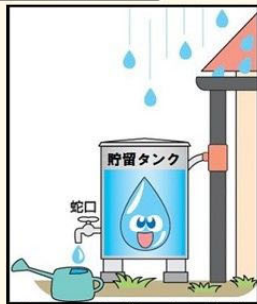
雨水貯留タンク(屋根に降った雨を貯めるタンク)
