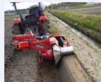
畦畔の再構築(漏水による法面前れの防止)
