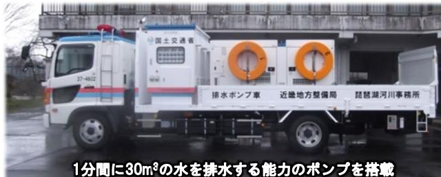
1分間に30m<sup>3</sup>の水を排水する能力のポンプを搭載
