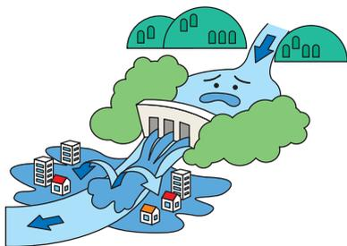
天ヶ瀬ダムの放流能力が小さく、また下流河道の流下能力も小さいため、ある規模以上の大雨が降ると、洪水をダムに貯めることができなくなります。
