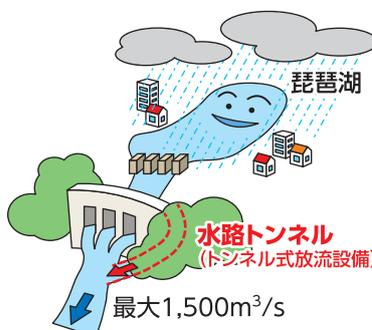
天ヶ瀬ダムの放流能力が増加するため、琵琶湖の水位を速やかに低下できます。これにより、大雨の場合琵琶湖周辺の洪水被害軽減が図られます。
