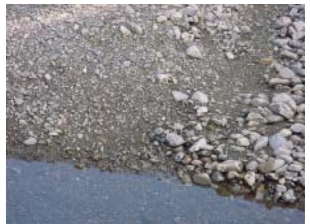
写真-4 高時川 7.5k 福橋付近河床材料(表層,H15年撮影)
