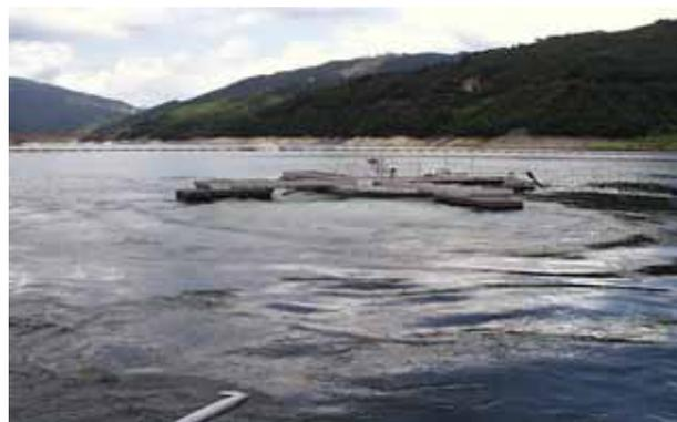
図 2.2.30 曝気装置概要図および曝気装置運転の様子
