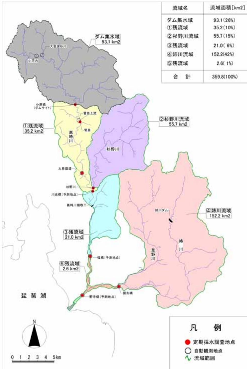
図 2.3.1 丹生ダム下流河川における水質予測地点とモデルにおける流域の取り扱い
