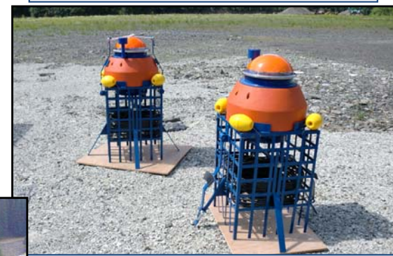
②投下型水位観測ブイによる水位の観測
