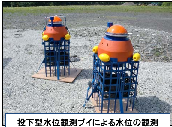
投下型の水位計による水位の自動観測
