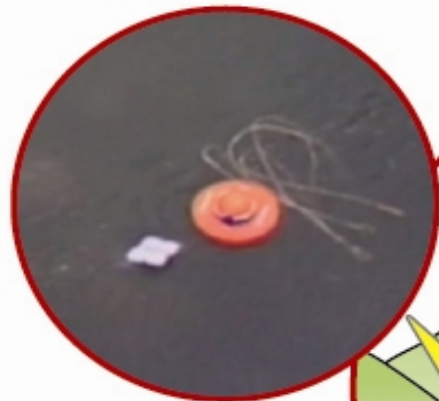
投下型の水位計による水位の自動観測
