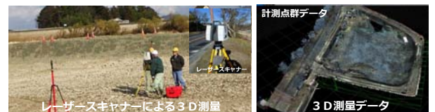
ICT起工測量（レーザーメスキャナー）
