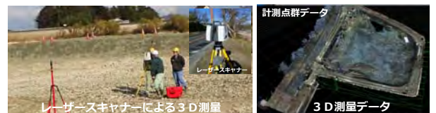
ICT起工測量（レーザーメーター）
