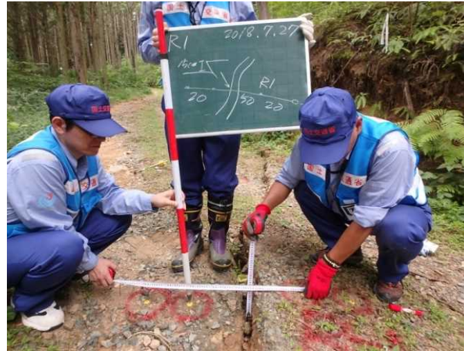
▲路面クラック調査(西予市)
