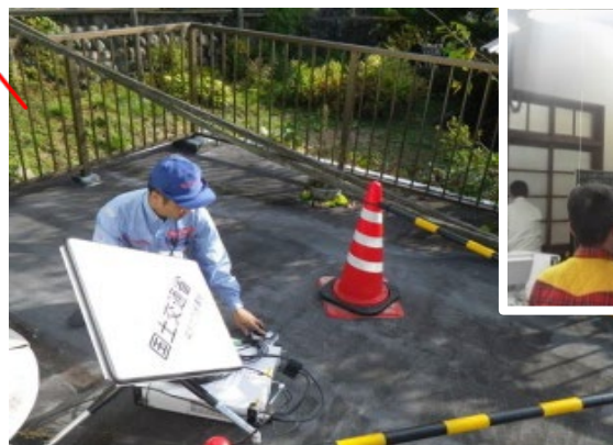
映像をKu-SAT(小型衛星画像伝送装置)による 被災箇所の監視
