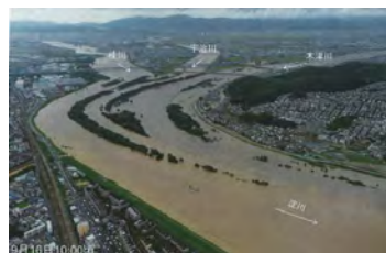
平成25年台風18号洪水時の三川合流地点のバックウォーター現象
