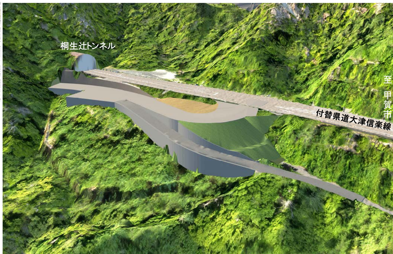
工事用道路イメージ
