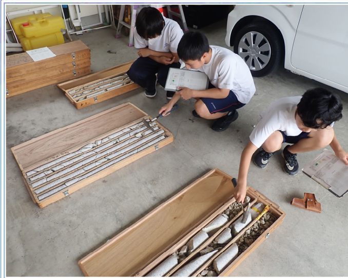
▲地質調査体験：岩級区分判定（ボーリング調査で採取した岩石の硬さ、形状、割れ目の状態から岩盤の状態を分類する）の様子
