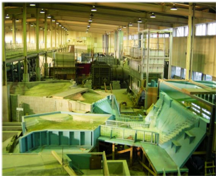
国立研究開発法人土木研究所における模型を使用した水理実験施設 (出典：国立研究開発法人土木研究所ホームページ)
