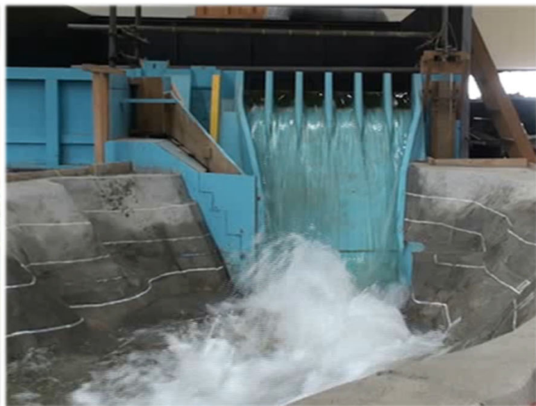
国立研究開発法人土木研究所における模型を使用した水理実験施設 (出典：国立研究開発法人土木研究所ホームページ)
