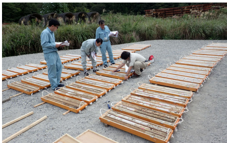
コア検査の実施状況（調査①） ボーリングを掘り終わった後に掘り出した岩石（コア）を並べ、状態を確認しています。
