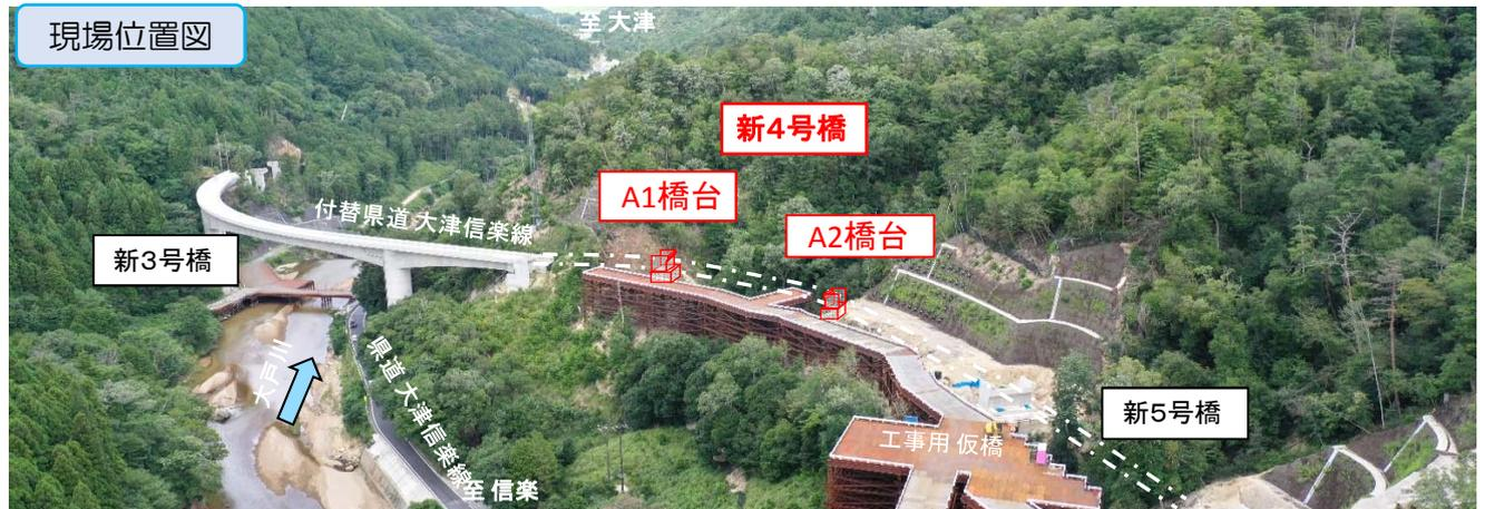
【工事の進捗】 A1橋台の深礎工を施工しています。 【今後の予定】 A2橋台の土留・仮締切と床掘を行います。
