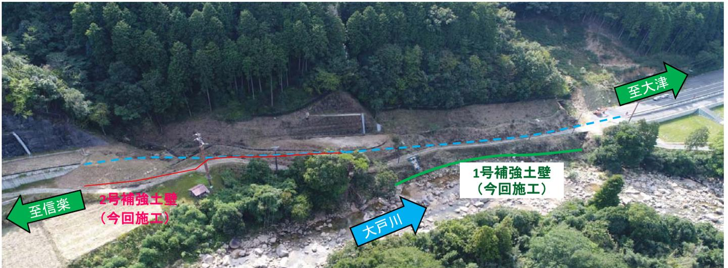
【現在の作業】2号補強土壁－掘削完了・地盤改良を着工します。1号補強土壁－年内は河川の仮締切を行います。
