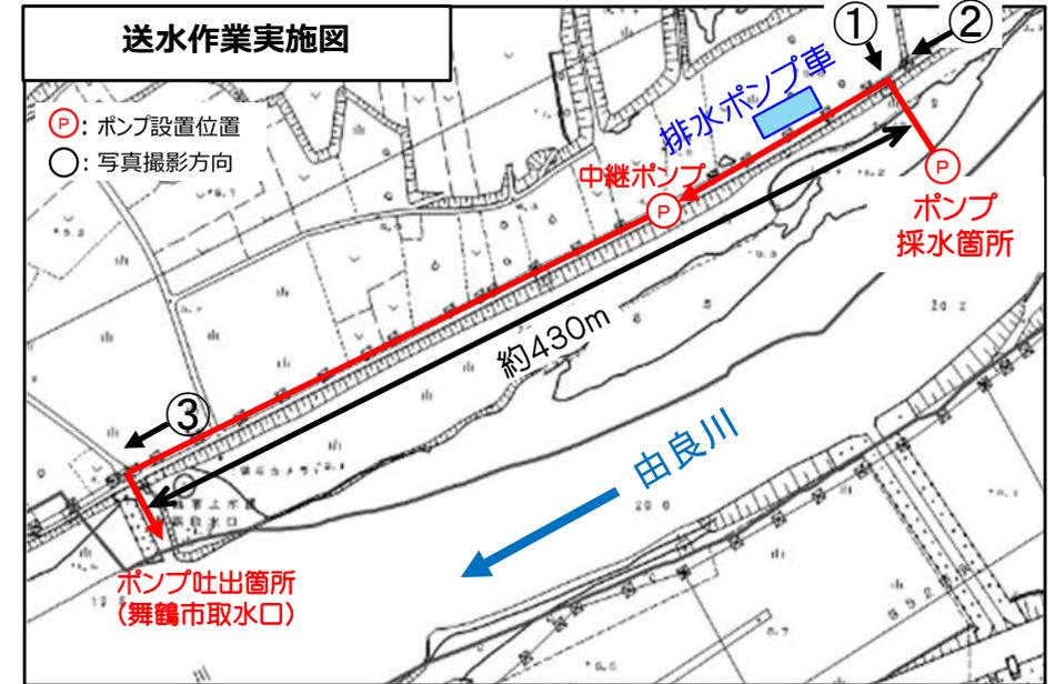
・ 約430m上流の塩分濃度の低い箇所にもポンプ2台を設置し、上水取水口へ送水。
