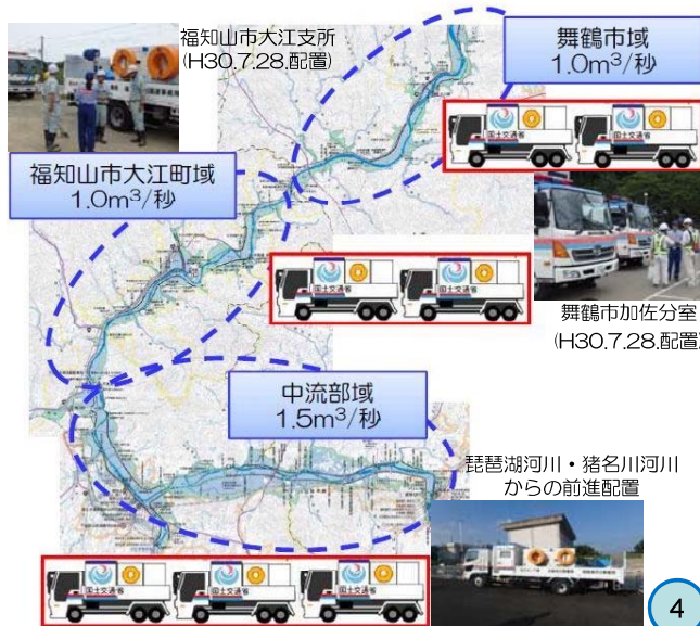
▲排水ポンプ車の配置
