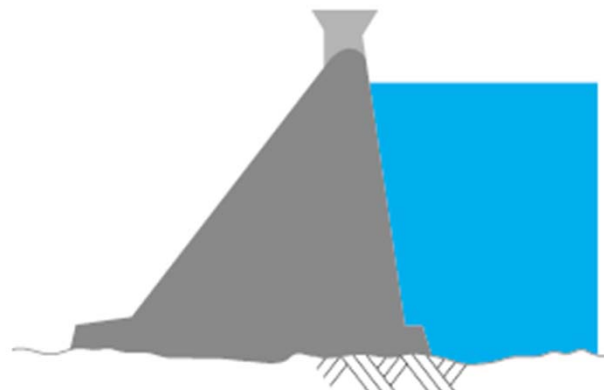
重力式コンクリートダム
