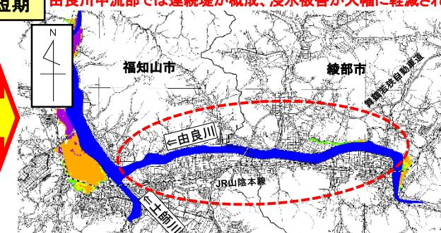
\*直轄管理区間において、昭和34年伊勢湾台風規模の降雨が発生した場合に、氾濫ブロックで被害最大となる1箇所を破堤させた場合の洪水浸水氾濫想定範囲
