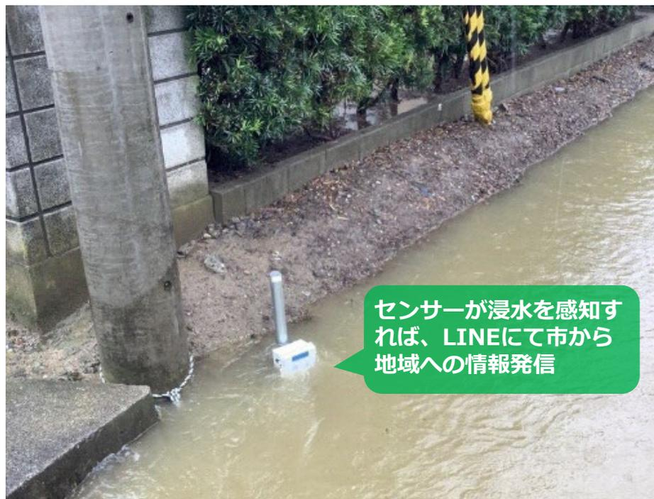
観音寺に設置の浸水センサー
