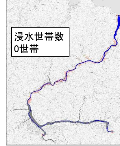
河道: 追加対策メニュー完了時点 外力: 気候変動考慮後の目標流量 (現行河川整備計画の対象降雨の降雨量を1.1倍した場合の目標流量)
