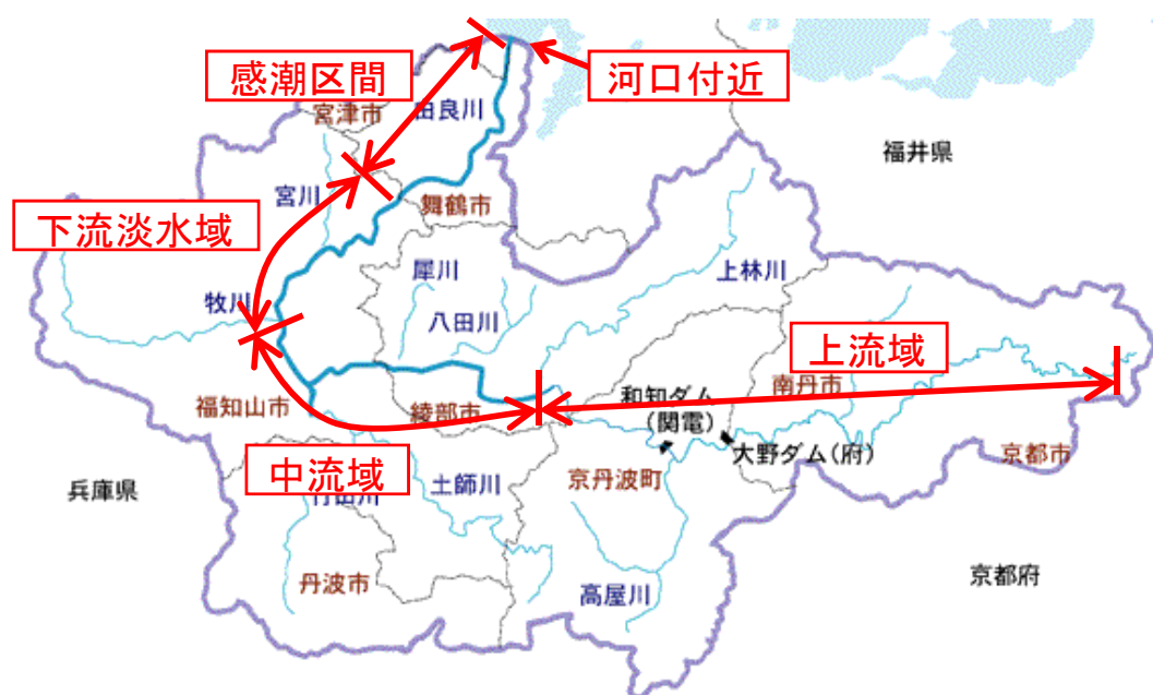
図 2.3.1 由良川の河道特性、地形特性、生物の生息・生育・繁殖状況を踏まえた区分
