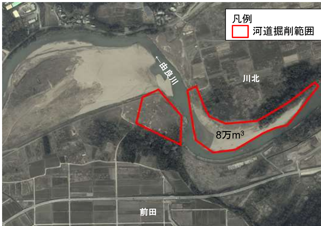
川北地区における河道掘削箇所
