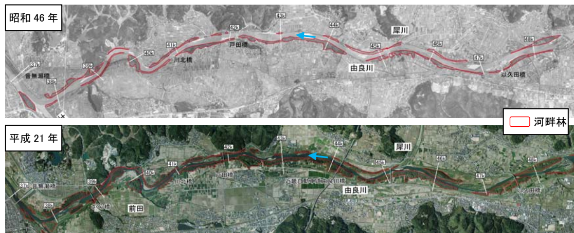
写真 2.4.4 由良川中流部の河道内樹木の分布範囲の変化
