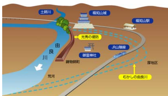
図 1.2.2 明智光秀による由良川の付け替え
