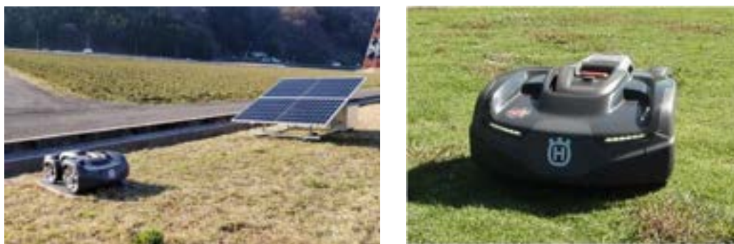
図 6.2.2 ロボット除草機による堤防除草の効率化
