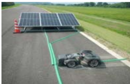
図 5.2.1 ロボット除草機による堤防除草の効率化
