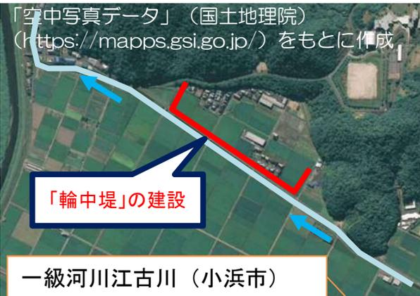
河川の氾濫による浸水被害から家屋等を防護する堤防(輪中堤)を建設
