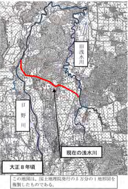
図2.2 浅水川の新川開削区間
