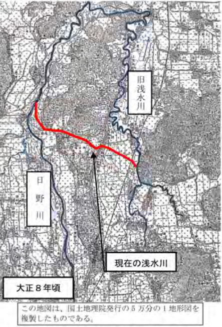
図2.2 浅水川の新川開削区間
