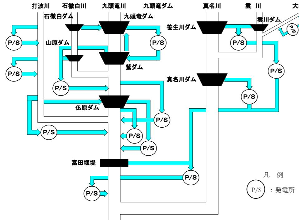
図 3.1 九頭竜川・真名川上流域における発電用水の利用系統
