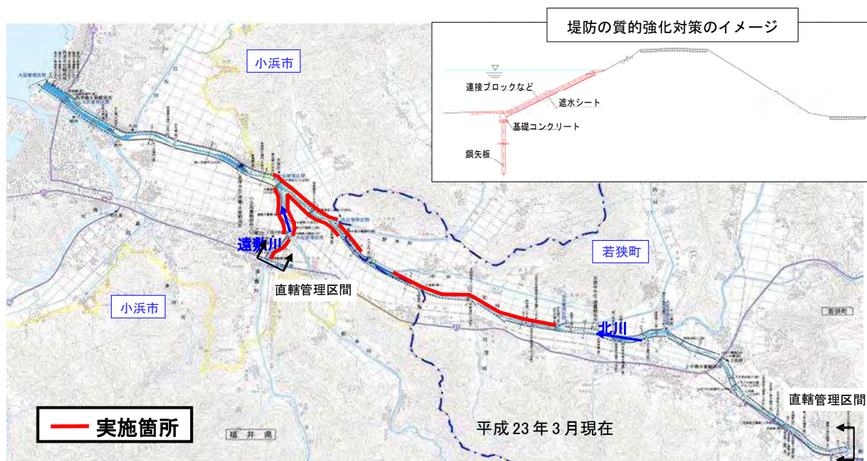
図 4.1.6 堤防安全性確保実施予定箇所
