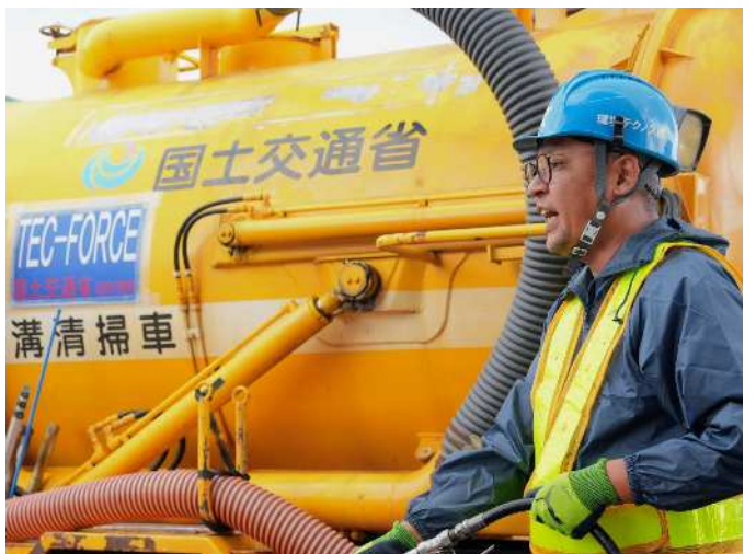
側溝清掃車と協力会社の作業員
