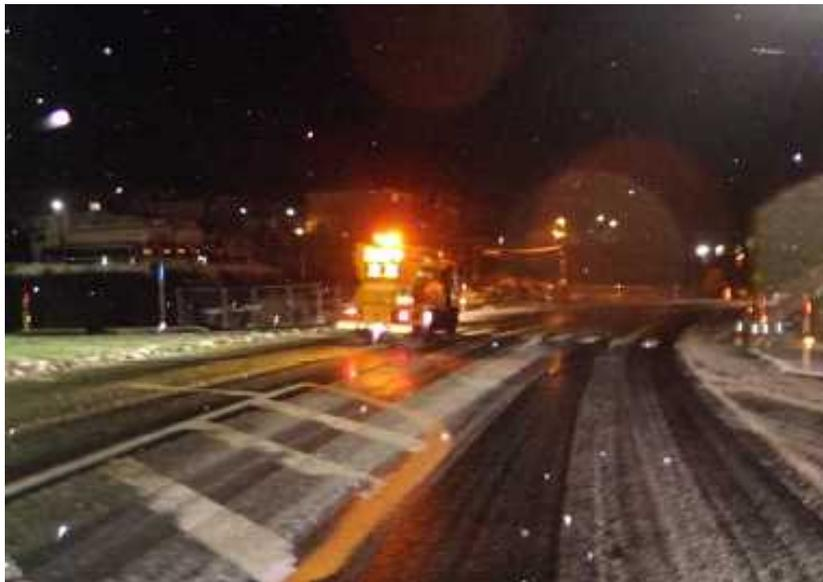
凍結防止剤散布車による作業状況
