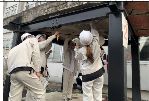
実習の様子(打音調査・ひび割れ調査)
