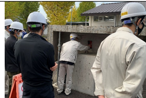
実習の様子(電磁誘導法・電磁レーダー法)
