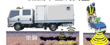
路面下空洞調査
