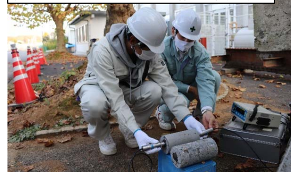
実習の様子(超音波伝播速度測定)
