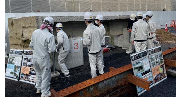
実習の様子(電磁誘導法・電磁レーダー法)
