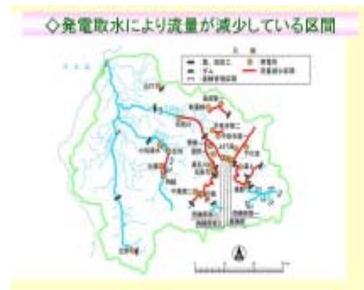
図3.44 発電取水により流量が減少している区間
