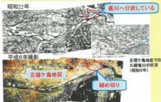
図2.6 五領ヶ島の裏川締め切り工事
