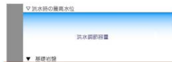
「水を貯めないダム」のイメージ図 ※洪水時のみ水を貯めます。
